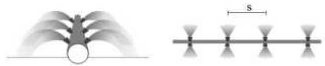
شکل ۱: نمای کلی از تخلیه‌کننده‌های چند مجرای (دیفیوزرها) فاضلاب‌های با شناوری منفی (Abessi and Roberts, 2014)
