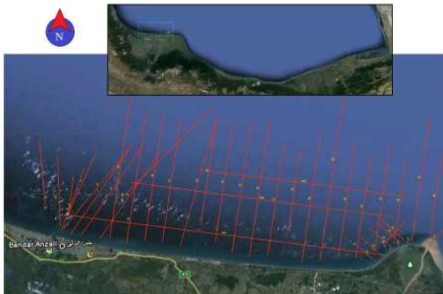
شکل ۱: مسیر و موقعیت پروفیل‌های ثبت شده از بستر دریا در نواحی مابین بندر انزلی و مصب رودخانه سفیدرود
