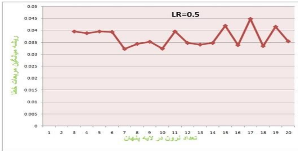
شکل ۱۴- نمودار تغییرات مقادیر RMSE و تعداد نرون لایه پنهان با نسبت یادگیری LR=0.5 Figure 14. Chart of changes in RMSE values and number of hidden layer with learning ratio LR = 0.5
