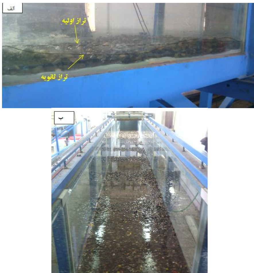
شکل ۶- تغییرات ریخت‌شناسی بستر بعد از آزمایش: الف) در راستای عرضی فلوم و ب) در راستای طولی فلوم Figure 6. Bed evolution after each experiment: a. at transverse direction and b. longitudinal direction of the Flume
