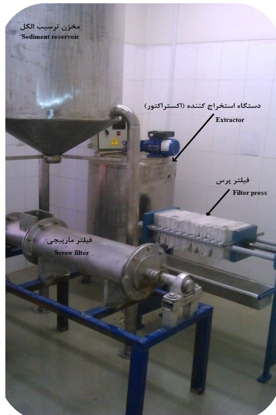
شکل ۲ - خط تولید نیمه‌صنعتی پکتین از ضایعات پرتقال
