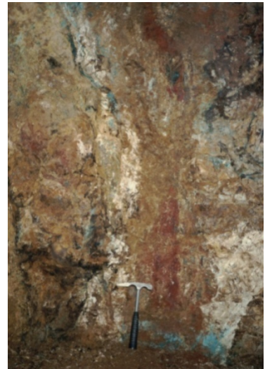
شکل ۱۳- نمونه‌ای از یک رگه کانی‌سازی مس همراه با اکسیدهای آهن در کانسار چیزه.
