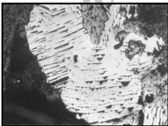
شکل ۱۷- تغییر جهت و شکل قالب‌های گالن ناشی از واکنش، \times 100
