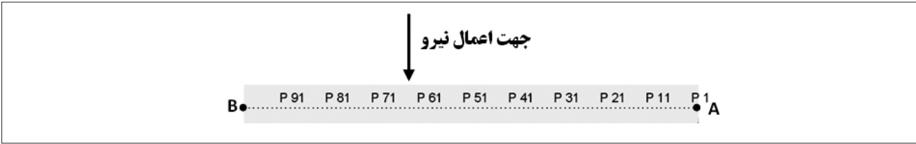
شکل ۷. ارزیابی توزیع کرنش مؤثر اعمالی در نمونه آزمایش در امتداد خط AB به ازای صد نقطه.
