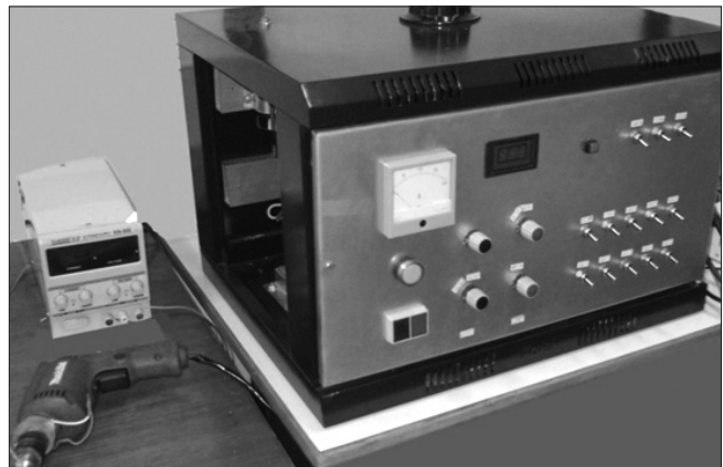
شکل ۱- دستگاه الکترواسپارک مورد استفاده برای پوشش دهی آلیاژ IN738LC
