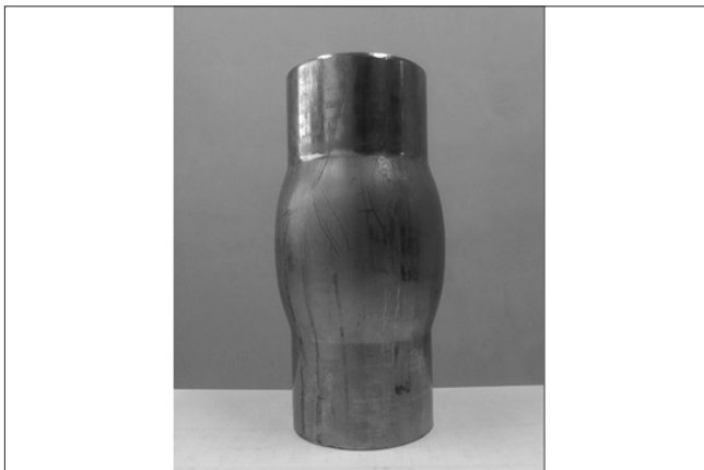
شکل ۸- لوله‌ی آزمایش شده در فشار ۳۰ MPa
