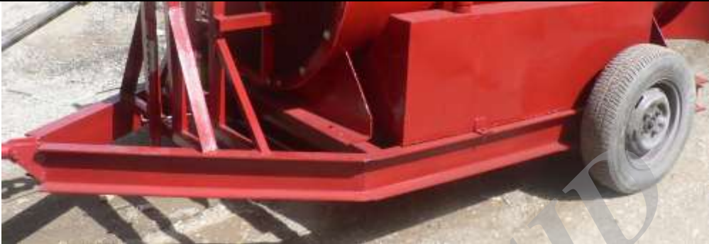
شکل ۴-۱۳: نمایی از شاسی و موقعیت چرخ‌ها، مخزن سوخت و سایر اجزاء دستگاه بر روی آن
