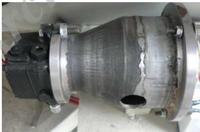
شکل ۳-۴: موتور پمپ و اتصال آن از طریق کوپل به بدنه پمپ
