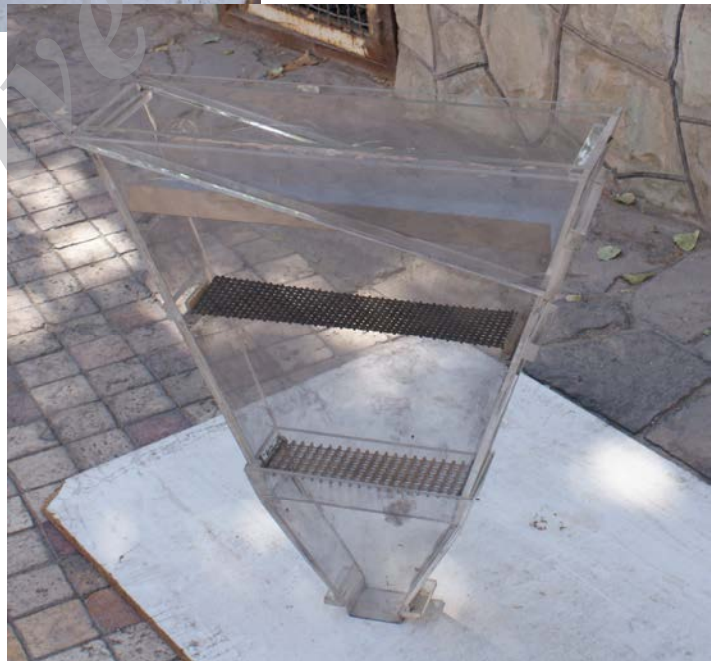
شکل 6-۳: تصویر قسمت مخروطی جداکننده واسطه سنگین هوایی
