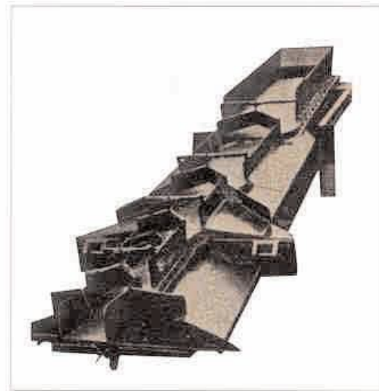
شکل ۱-۳: یک نمونه میز لرزان هوایی (Donnelly; ۱۹۹۹).
