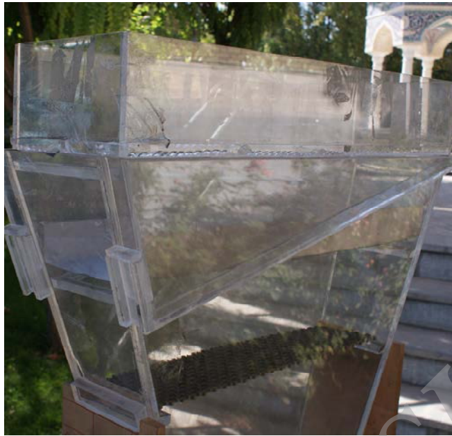
شکل ۶-۸: نحوه قرارگیری قسمت مکعبی بر روی مخروط ناقص
