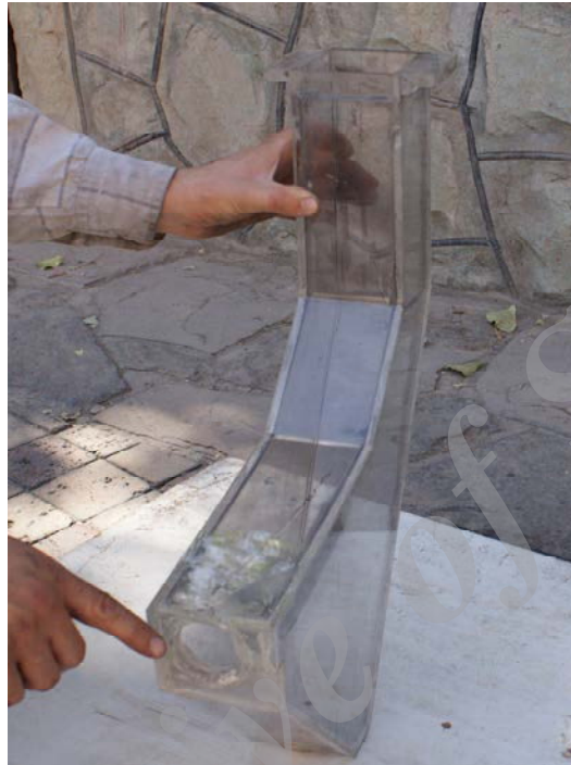
شکل ۶-۴: مخزن تعبیه شده در پایین گلوگاه؛ مجرای با سطح مقطع دایره محل اتصال به پمپ هوادهی است.
