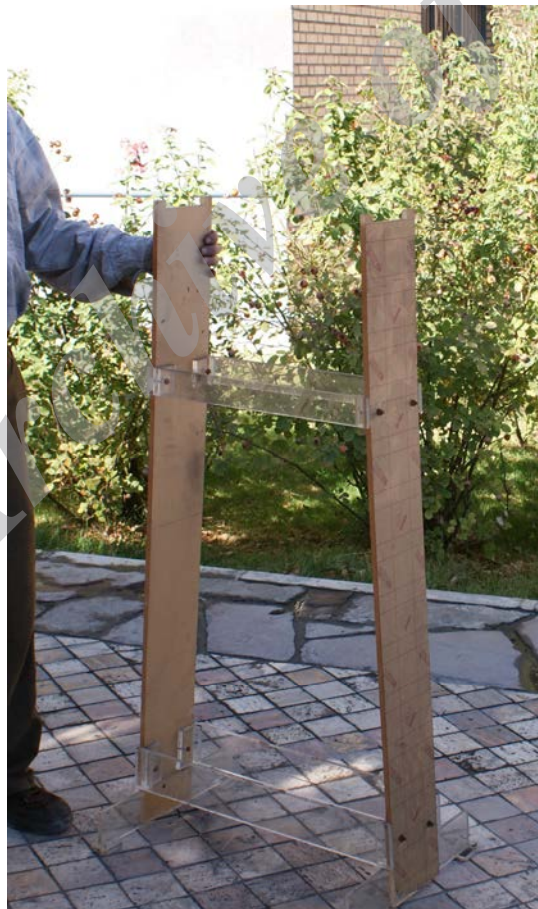
شکل 6-6: تصویر سازه نگهدارنده جداکننده واسطه سنگین مخروطی
