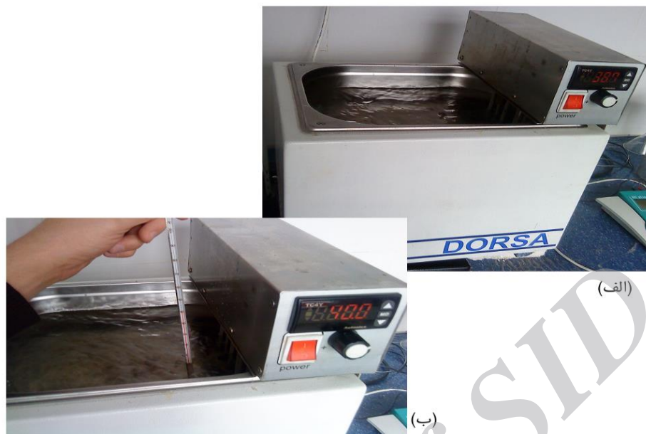
شکل ۴-۲: الف) نمایی از حمام روغن ب) چگونگی تنظیم دما.
