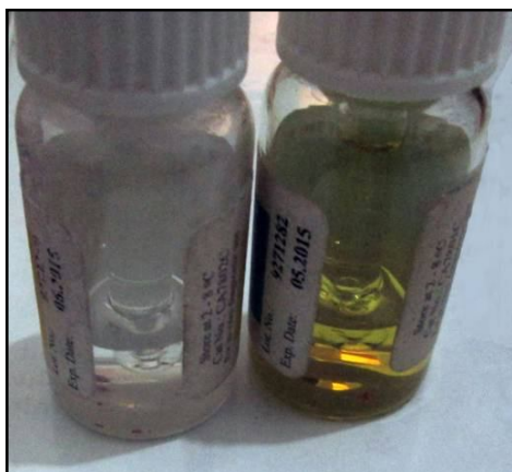
نگاره ۱: محلول زینکیت استفاده شده برای تشخیص کانی‌های روی
