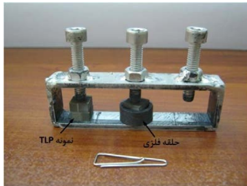
شکل 5-2- فیکسچر مورد استفاده جهت انجام فرایند TLP.
