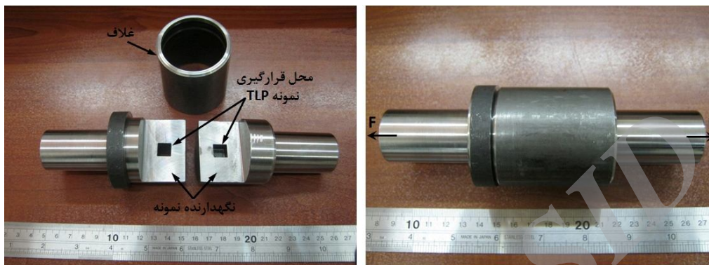
شکل 5-3- فیکسچر مورد استفاده جهت تعیین استحکام برشی نمونه‌های TLP.
