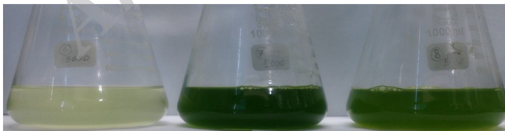
شکل 16- نمونه‌های جلبکی در شدت نور 5000 لوکس و pH های مختلف (6، 7 و 8) در روز سوم رشد.
