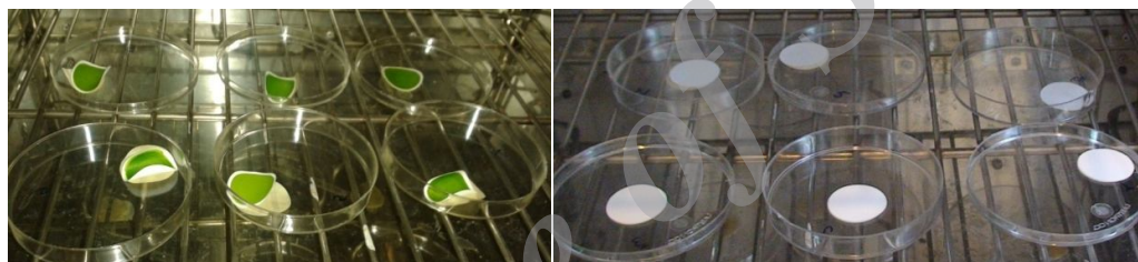
شکل 6- اندازه‌گیری میزان بیومس در طی دوره رشد با استفاده از فیلتر 0/45 میکرون
