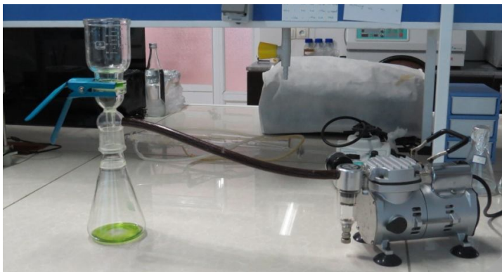
شکل 5- استفاده از پمپ خلاء به منظور فیلتر نمودن سوسپانسیون جلبکی
