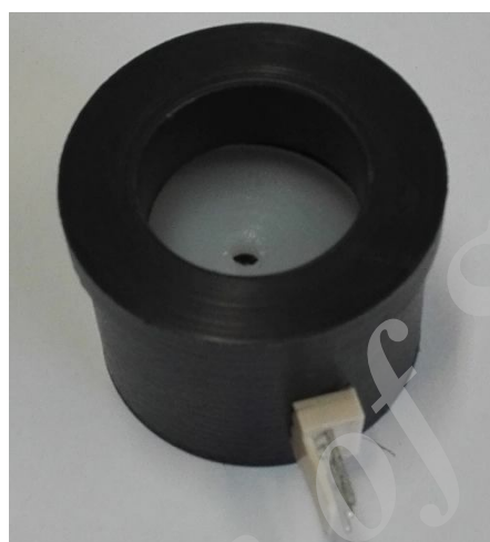
شکل 3-13- محفظه حسگر الکتروشیمیایی از جنس PTFE
