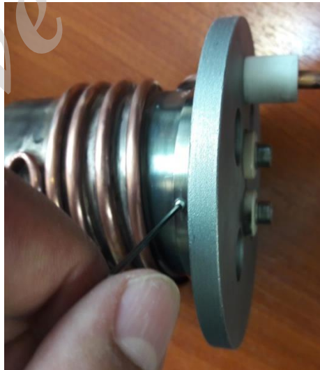
شکل ۳-۲۷- نصب آند و آبگرد آن روی توپی متصل به یوغ پائینی
