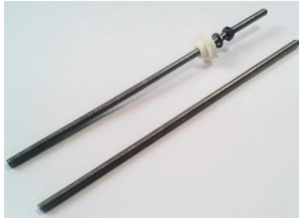
شکل ۳-۳۳- نصب مهره، واشر و سرامیک نری روی پیچ ۱۸ سانتی متری
