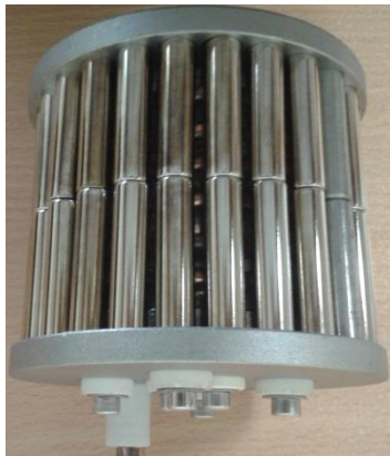
شکل ۳-۶- بالا: نقشه جوشن‌ها؛ پائین: نصب آهنرباها و جوشن‌ها
