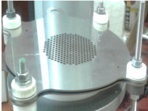
شکل ۳-۳۶- نصب توری ها قبل از تنظیم
