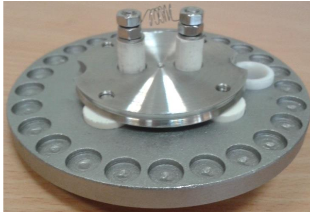
شکل ۳-۱: رشته کاتد و پایه های اتصال آن
