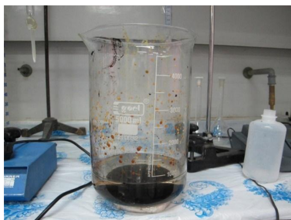
شکل ۱۶-۵: جدا کردن نانوذرات سنتز شده با مگنت
