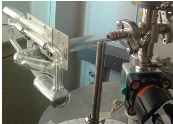
شکل ۳-۷: شیر دستی و اتصالات خلأ متصل به سنجه مک لئود
