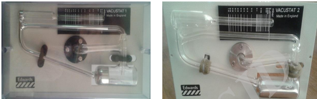
شکل ۳-۵: دو نوع خلأسنج مک لئود با مخزن حاوی مایع جیوه
