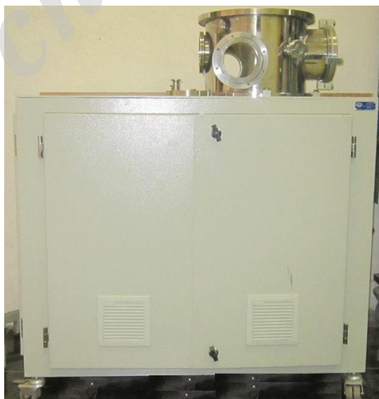
شکل ۳-۱۴: محفظه خلأ قرار گرفته بر روی کابینت
