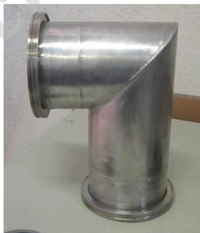
شکل ۳-۱۰: زانویی اتصال پمپ به محفظه خلأ
