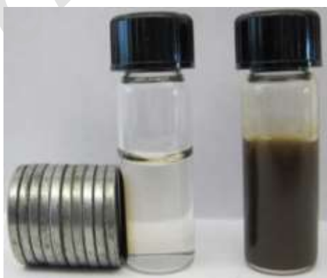
شکل ۱) استفاده از آهن ربا برای جدا سازی ترکیبات متصل به نانوذرات مغناطیسی
