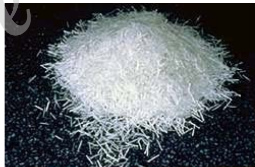
شکل ۱-۵: الیاف آسیاب شده (شکل سمت چپ) و الیاف کوتاه شیشه (شکل سمت راست).
