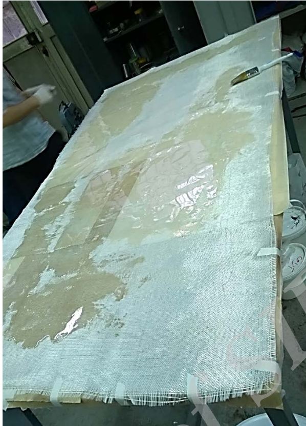
شکل ۶-۱: قرار دادن لایه ابتدایی در ساخت ورق‌های کامپوزیتی در آزمایشگاه
