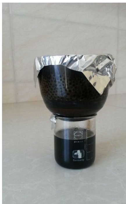
شکل ۴-۹: مخلوط نانوسیال - نفت درون فضای متخلخل و بشر زیرین جهت جمع آوری سیال خروجی
