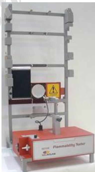
شکل ۱-۲۳: دستگاه تست عمودی طول سوختگی ساخت شرکت Shirley انگلستان مطابق استاندارد ISO 15025
