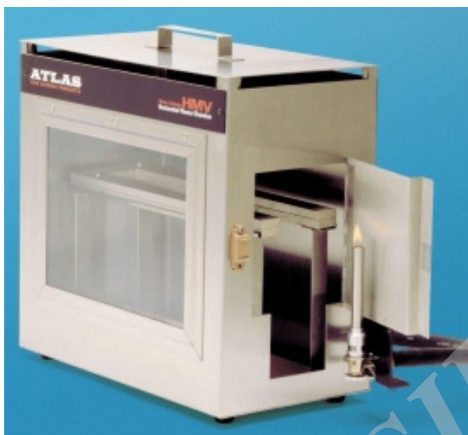
شکل ۱-۲۲: دستگاه تست افقی طول و سرعت سوختگی ساخت شرکت SDL Atlas انگلستان مطابق با استاندارد ASTM D5132
