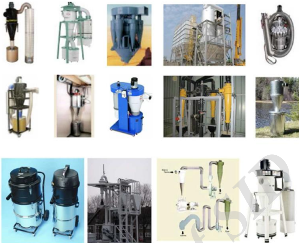
شکل ۲-۲- انواع جدا کننده‌های سیکلونی موجود در صنایع.
