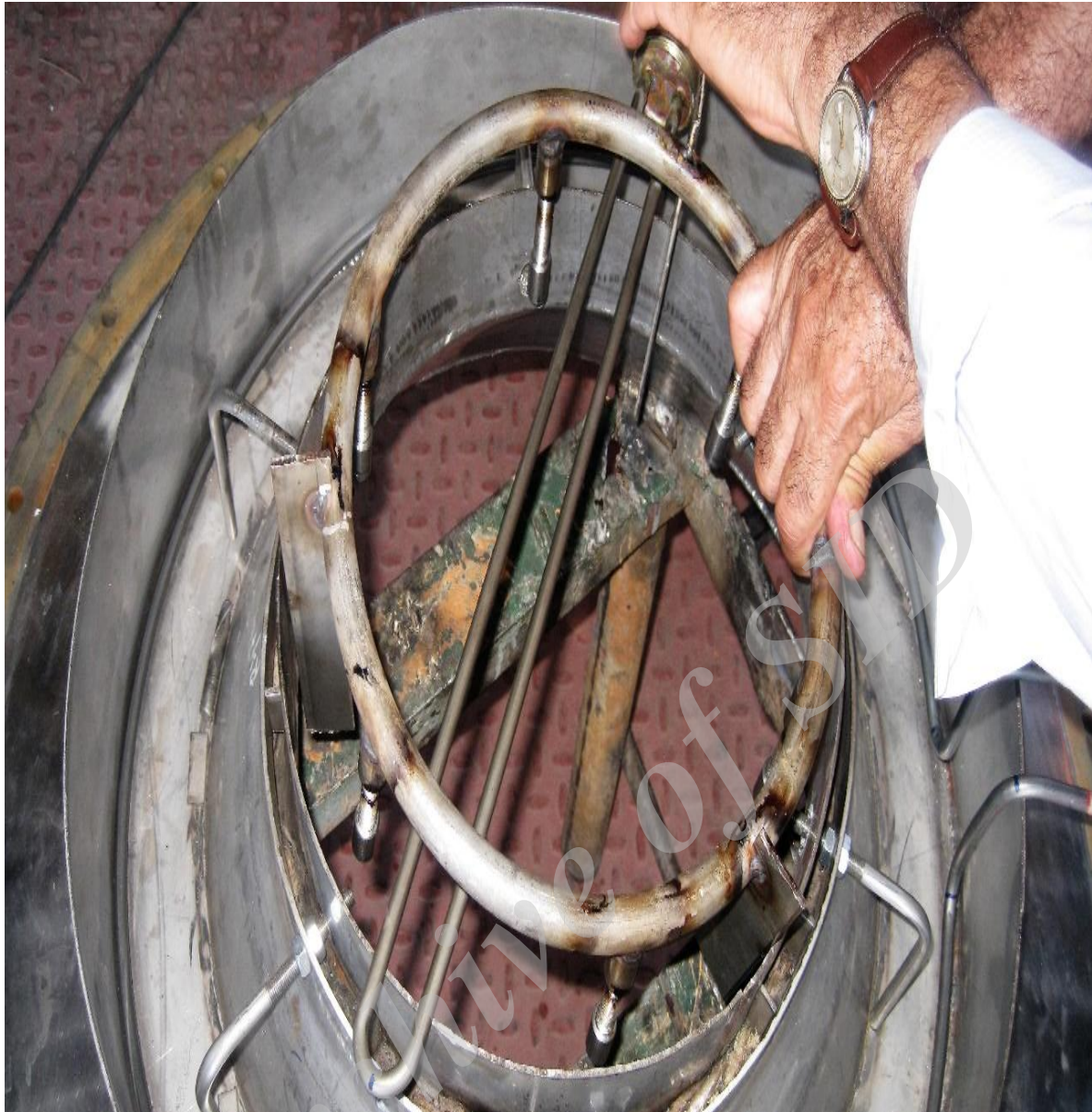
شکل ۱-۱۸- ساخت و تنظیم نازل با شش هد پاشش و نصب آن بر روی درب مخزن انبساط.
