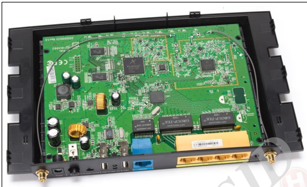
شکل ۱۰: نمونه‌ای از تجهیز WDR3600 متعلق به شرکت TP-Link که در آن از Atheros 9344 استفاده شده است.
