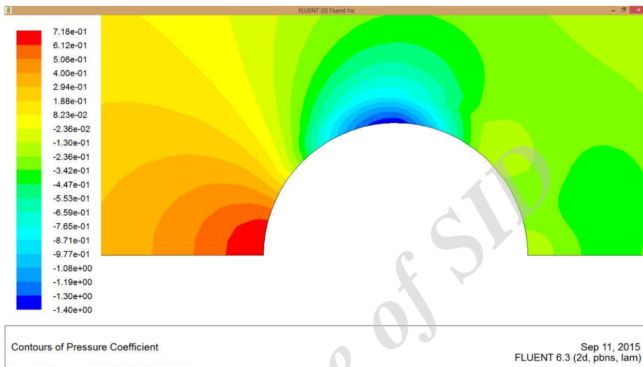
شکل ۵۶: کانتور فشار جریان آرام C
