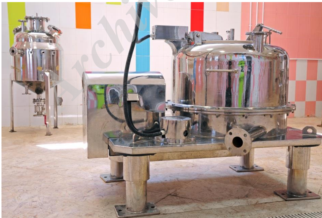
شکل (۱-۳) سانتریفیوژ Best Engineering مورد استفاده برای جداسازی حلال هگزان
