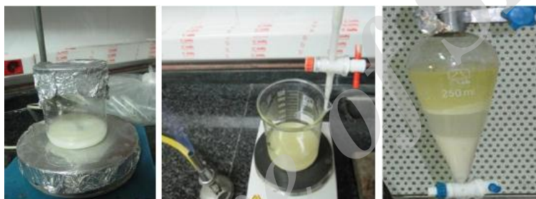
شکل ۳-۱- کپسولاسیون باکتری در آلژینات سدیم
