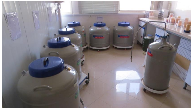
نگهداری سویه‌ها در تانک ازت برای نگهداری طولانی مدت (۴ ویال به ازای هر سویه)
