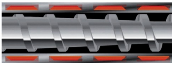
شکل ۷- ماریچ اکسترودر داخل ماردون
