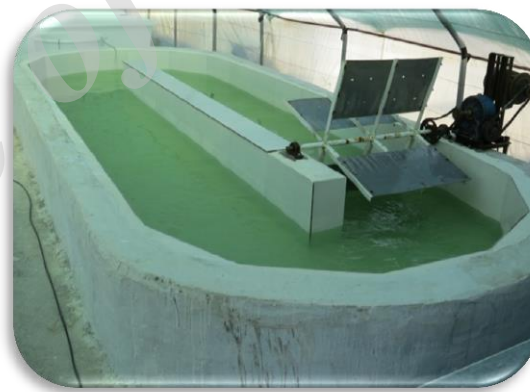
شکل ۸. پرورش جلبک در استخر ۴۰۰۰ لیتری در کارگاه کشت جلبک
