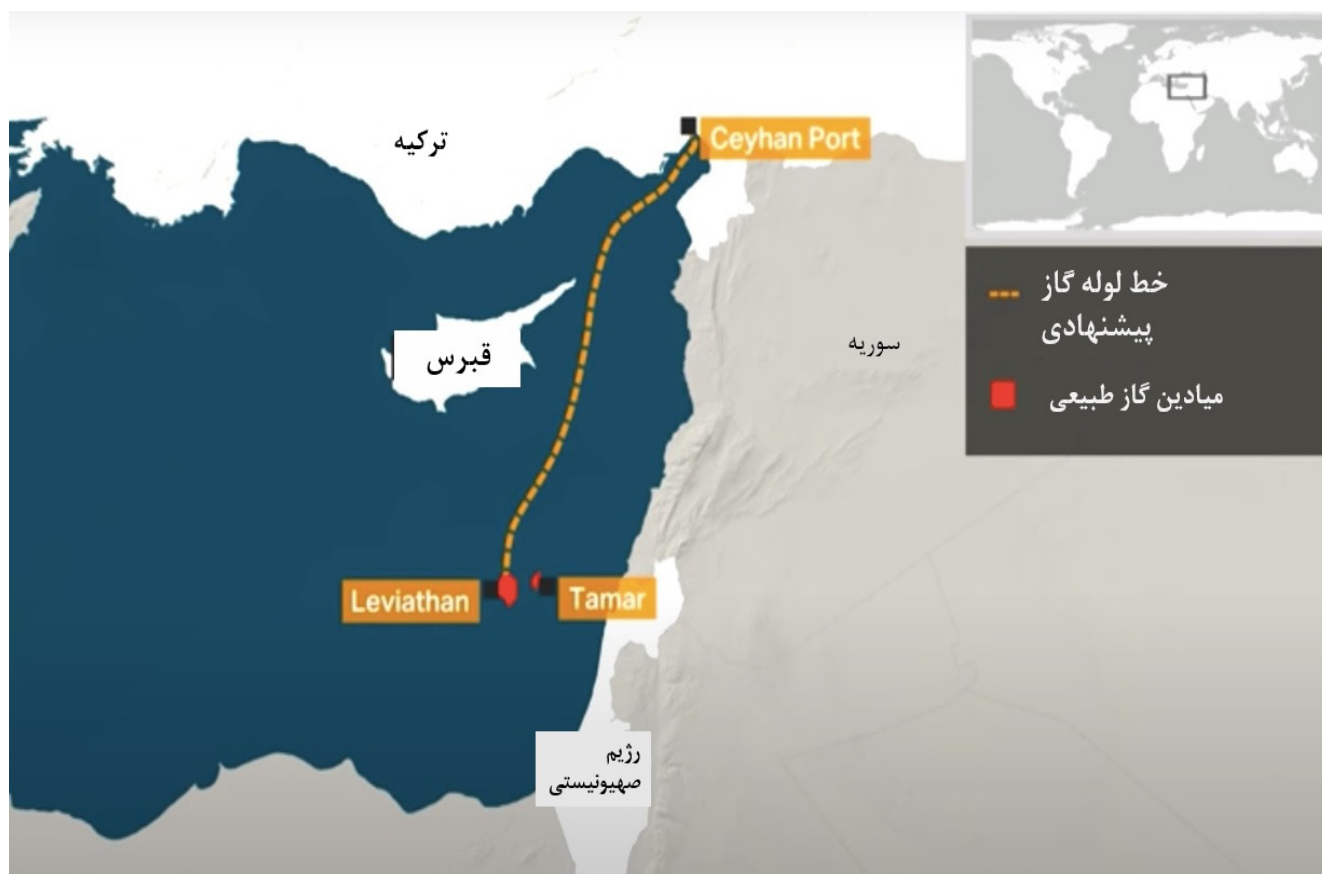
شکل ۵. مسیر خط لوله گاز ترکیه
