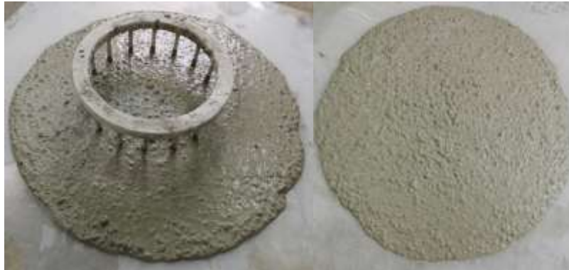
شکل ۲- آزمایش‌های کارایی شامل جریان اسلامپ، T_{50} ، حلقه J و شاخص پایداری چشمی
