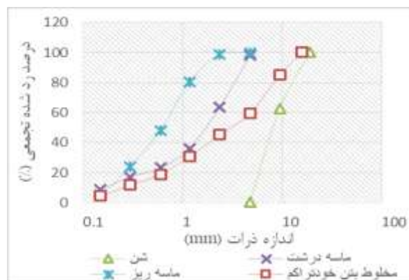
شکل ۱- منحنی دانه‌بندی سنگدانه مصرفی
