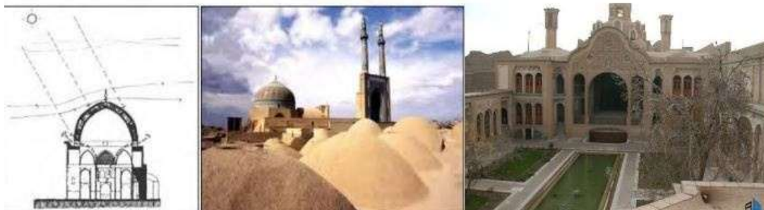
سمت راست استفاده از مصالح بومی در اقلیم گرم و خشک، سمت چپ گنبد دو پوش یا دو پوسته، عایق حرارتی با ضریب انتقال حرارت بسیار پایین
