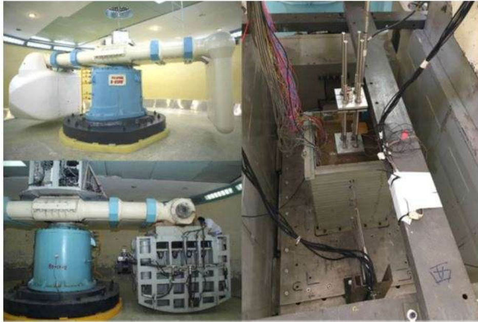
شکل شماره (۸) : میز لرزه‌ای سانتریفوژی ساخته شده در کره [۴۲].
