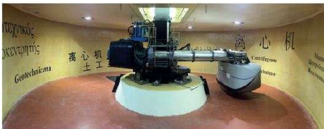
شکل شماره (۵) : نمایی از سانتریفوژ ژئوتکنیکی [۳۶].
