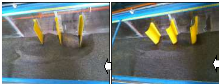
شکل (۶): آبشستگی آزمایشگاهی پیرامون سری آبشکن تیغه‌ای و چوگانی با دبی ۲۰ لیتر بر ثانیه
