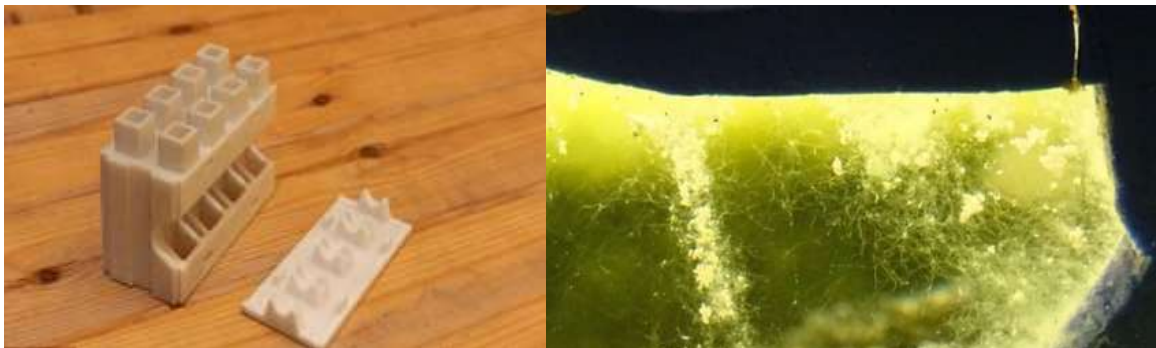
شکل شماره (۴): نمایی از شکل کلی و ساختار بیافی آجر هوشمند. [۹]
