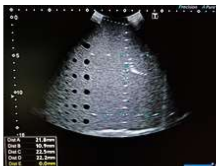
شکل ۱- تصویر فانتوم قابل مشاهده در دستگاه اولتراسوند پزشکی
