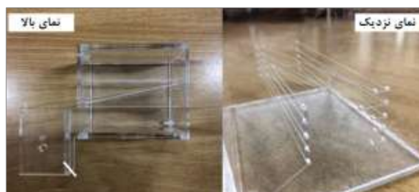
شکل ۳- نمونه اولیه از یک طراحی فانتوم N که ترتیب ۵ ثابت N را نشان می‌دهد.
