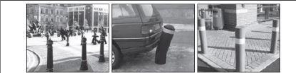
راه مسدود کن مثل تیرک: تعریف و تقسیم عرصه. هدف‌های اصلی در این نوع مبلمان عبارت‌اند از: احترام به پیاده و محدود کردن عبور
