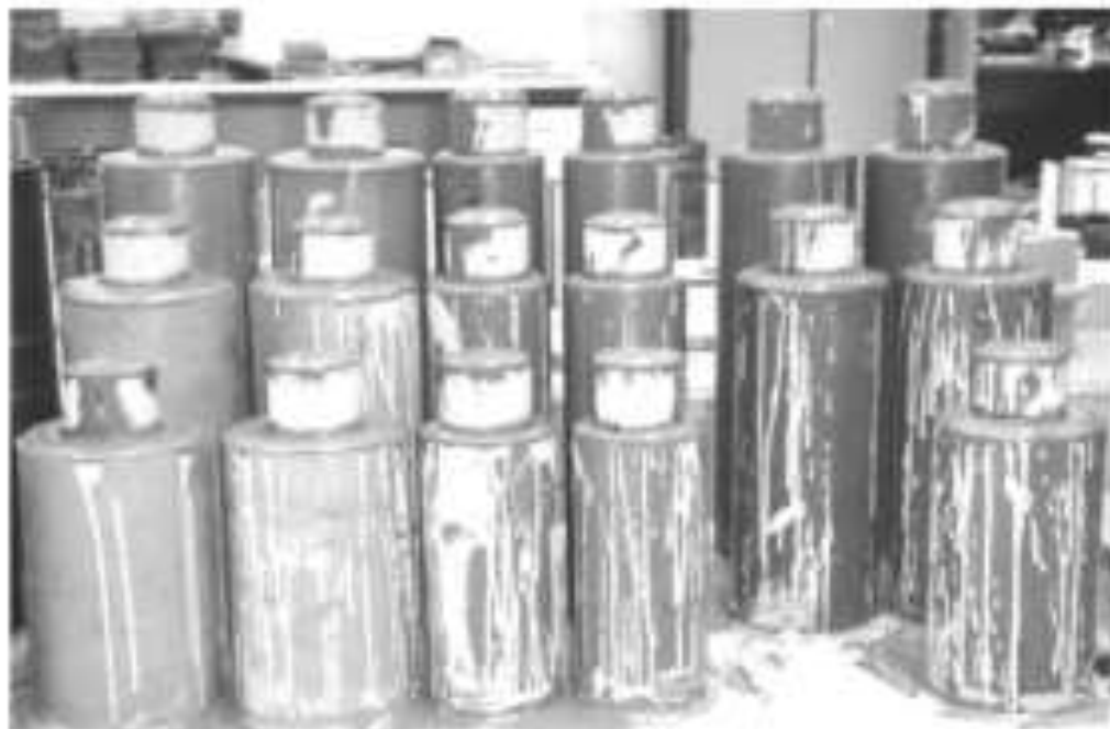
شکل ۱- نمونه‌های ریزشمع پر شده با دوغاب (Veludo et al, 2012)
