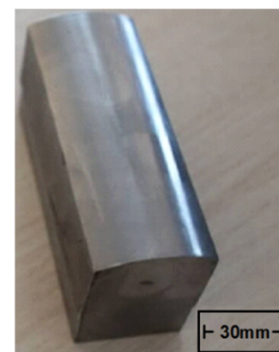
شکل 2- (الف) نقشه و (ب) تصویر بلوک با انحنا 41/36 میلیمتر
