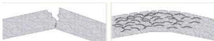
شکل ۳. مقایسه بتن با الیاف و بدون الیاف در شکست
