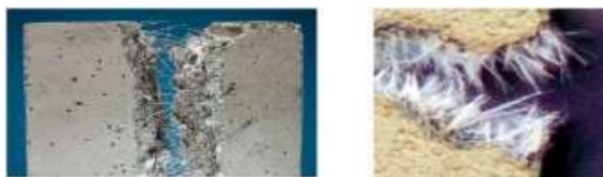
شکل ۱. نمونه های بتن با الیاف پلیمری و الیاف فولادی (۱)
