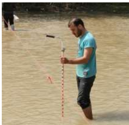
شکل شماره (۷). نمونه‌ای از نحوه برداشت بار معلق با استفاده دستگاه نمونه بردار بار معلق (US DH-48)
