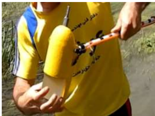
شکل شماره (۵). نمونه‌ای از دستگاه نمونه بردار بار معلق (US DH-48)
