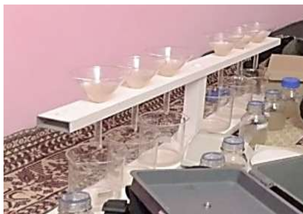
شکل شماره (۸). نمونه‌ای از عملیات فیلتراسیون برای تعیین غلظت بار معلق
