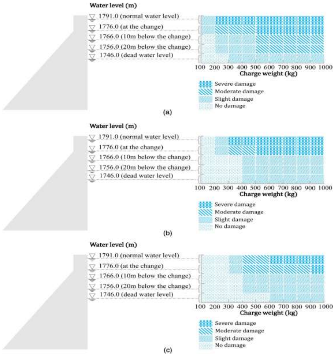
شکل ۲۱. روابط وزن مواد منفجره-سطح آب مخزن برای سطوح آسیب مختلف با فاصله توقف (الف) ۲ متر (ب) ۱۰ متر و (ج) ۱۵ متر.
