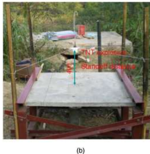
شکل ۸. سطح بالایی دال RC تحت انفجار (الف) نتایج عددی و (ب) نتایج تجربی
