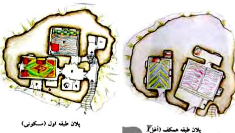
تصویر ۶: نمونه ای از کران های مسکونی کندوان (منبع: گرجی، مهلبانی و سنائی، ۱۳۸۹)
