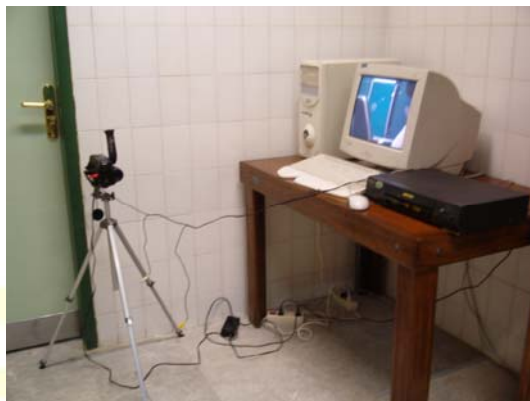
شکل ۱: اجزاء سیستم WEPAS شامل دوربین فیلم‌برداری، ویدئو، کامپیوتر مجهز به کارت ویدئویی (Capture Card) و نرم‌افزار WEPAS.
