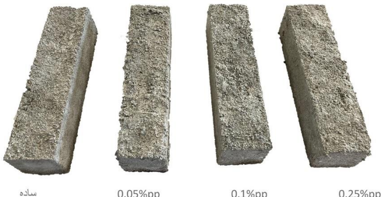
شکل شماره ۳: نمونه های خمشی تهیه شده با درصد های مختلف الیاف
