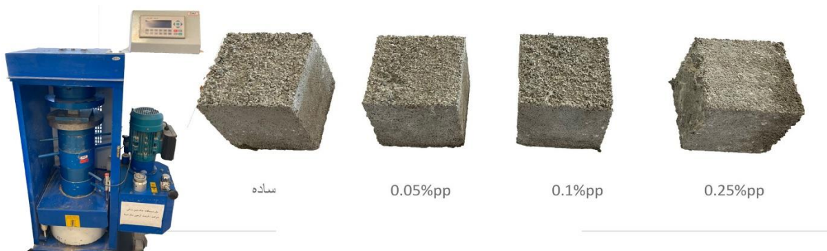
شکل شماره ۱: نمونه های فشاری تهیه شده با درصد های مختلف الیاف
