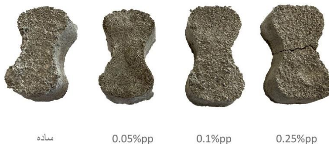
شکل شماره ۲: نمونه های کششی تهیه شده با درصد های مختلف الیاف
