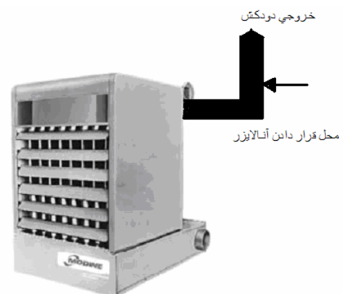
شکل (۲) محل قرار گیری آنالایزر برای اندازه گیری درصد هوای ثانویه
